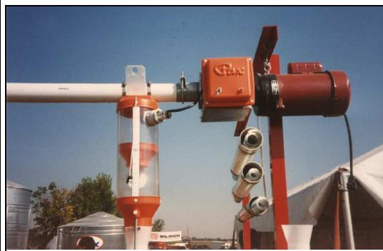
DOL 43R stopper opfyldning i et tørfoderanlæg. Føleren er placeret i sidste faldrør.
