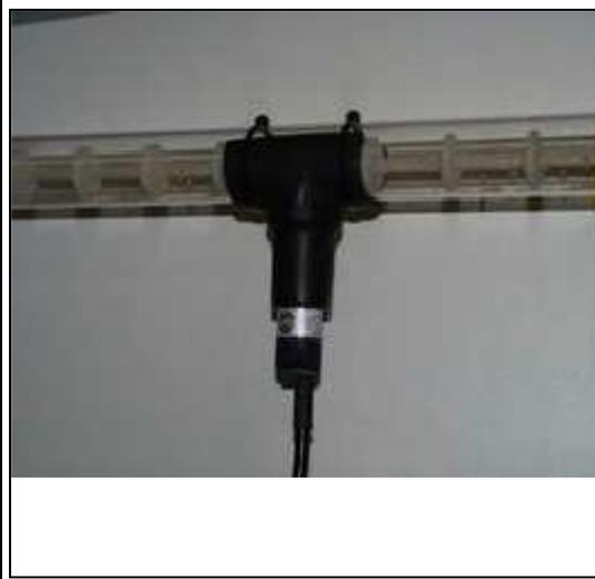
DOL 45-T stopper foderanlægget, når rørsystemet er fyldt op. ON-delay indstillingen tillader siddende foder i røret at køre forbi føleren, når anlægget igen startes fra foderstyringen.
