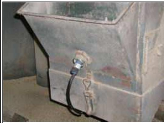
DOL 43R som niveauvagt i hammermølle. Stopper tilførsel ved ophobning
