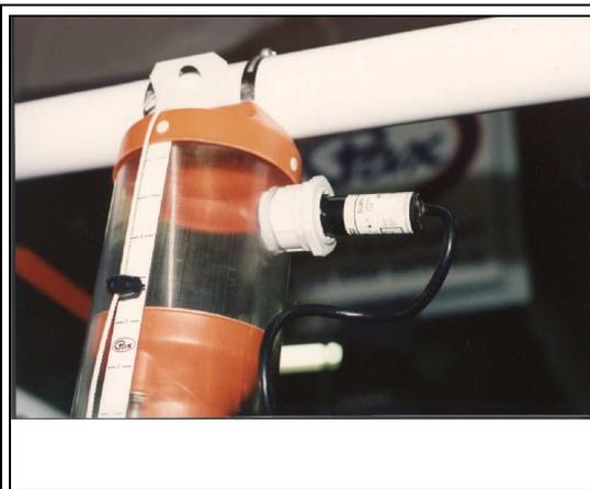
DOL 43R stopper opfyldning i et tørfoderanlæg. Føleren er placeret i sidste faldrør.
